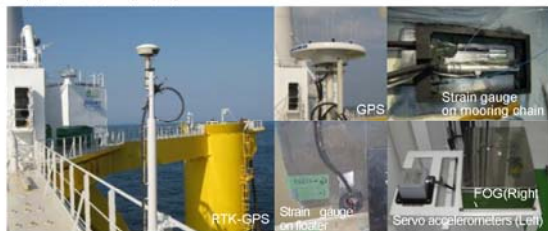
図 3. 風車・浮体上の観測機器
