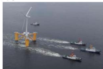
図 11. 2MW 風車搭載コンパクトセミサブの曳航
