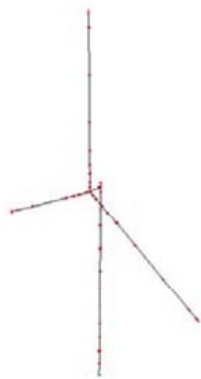
図5 (a) 実風車 (b) 多質点風応答解析モデル
