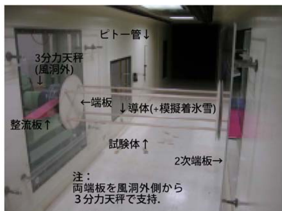
図2 測定部内の試験体取付け状況
