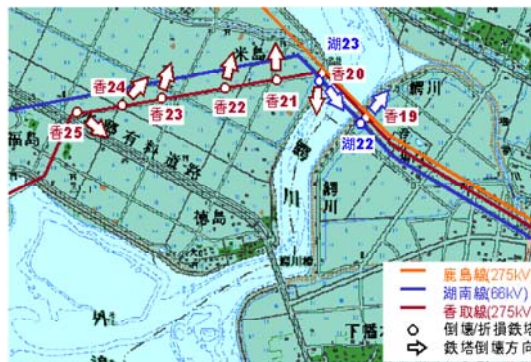
図 2 倒壊した送電鉄塔の分布
