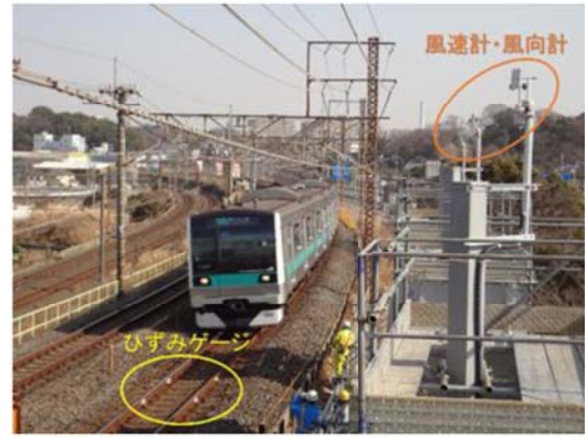
図 14 営業路線における輪重・風向風速測定試験の様子
