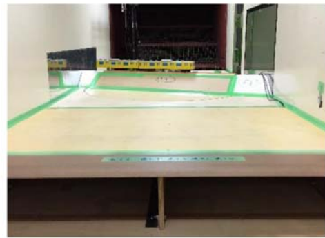
(b) 盛土上に設置した車両模型 (仮床上)
