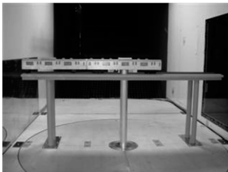
図7 車両と高架橋の模型設置状況
