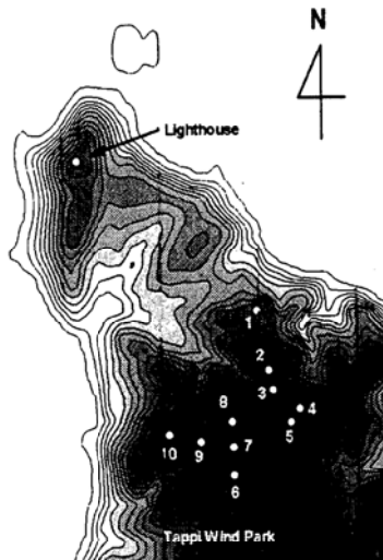
図10 竜飛ウインドパーク内の風車の配置図
