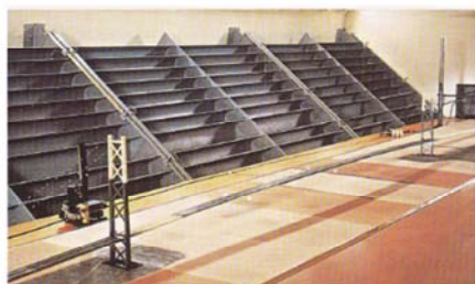
図1 明石海峡大橋箱桁案の全橋模型実験
