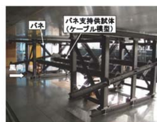
図4 並列ケーブルの実験装置の設置状況 10)
