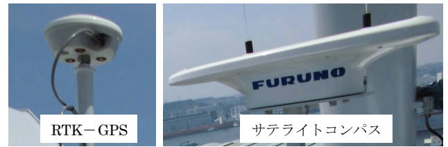
図4 浮体動揺観測機器
