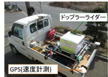
また、軽トラックの移動速度を高精度に求めるために、RTK GPSによる計測を同時に行った。
