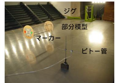
図3 部分模型の架設状況
