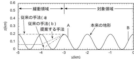
図3 地形の断面図と各種の境界処理
