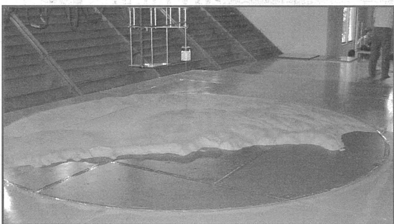
上/風車の立地を検討するため、風洞内に置かれた巨大な積丹半島付近の地形模型。上部のセンサーでは、1秒間に1000回の風の変化を測ることができる。 左/日本一の風洞の断面図。オープンキャンパスなどでは見学も可能だ。
