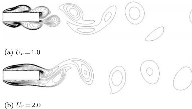
図-12 B/D=4 鉛直たわみ強制振動時の瞬間渦度場 (加振振幅 0.02D , 最大揚力時)
