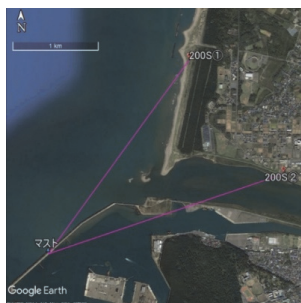
図9 観測タワーとスキヤニングライダーの設置位置 8)
