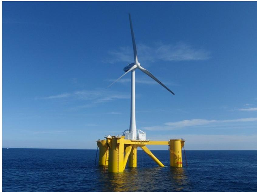
2000kW ダウンウインド型浮体式洋上風力発電設備「ふくしま未来」（福島洋上風力コンソーシアム提供）
