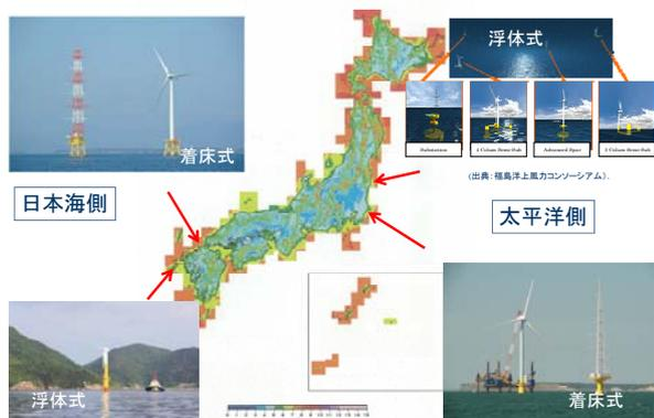
図2 わが国の着床式と浮体式洋上風力発電の実証研究
