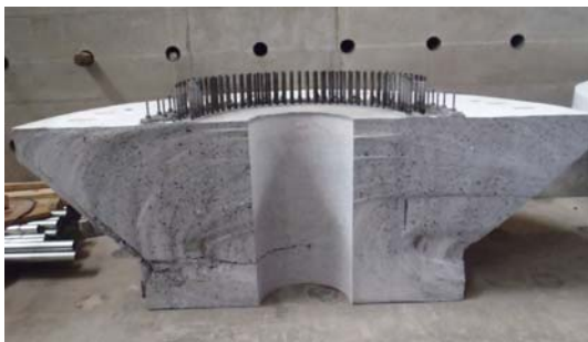
図 14 基礎の縮小模型試験体
