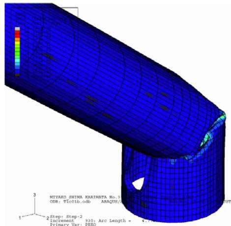
図-5 FEMによるタワーの応力解析例<sup>9)</sup>
