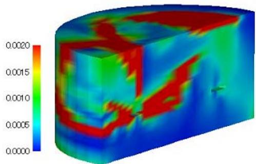
図-6 FEMによる定着部の応力解析例<sup>11)</sup>
