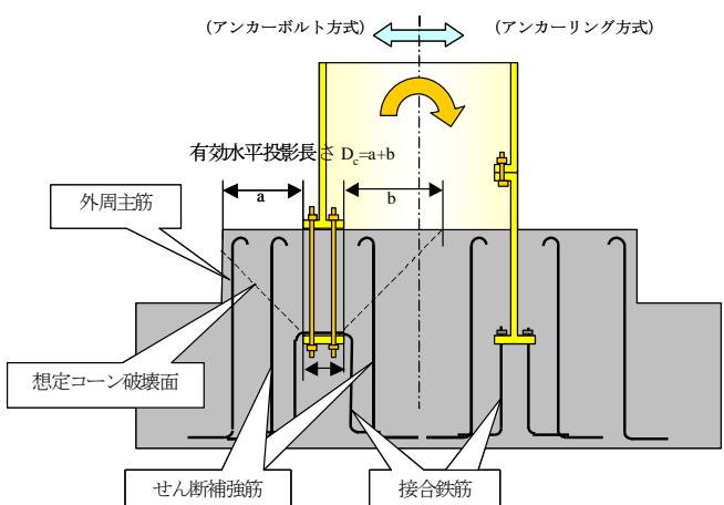
図-7 コンクリートのコーン状破壊面の有効水平投影長さと各種鉄筋の定義
