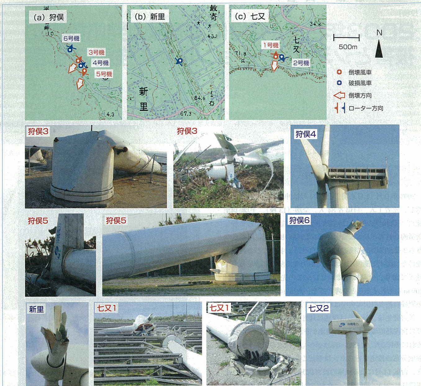
図-3 各風車の位置、倒壊方向、ローターの方向および被害状況
